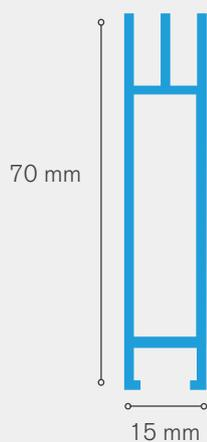
Le profilé EQ-70 est un profilé très léger pour former un cube, idéal pour recouvrir les 6 faces avec un textile imprimé avec tendon. Ces cubes sont faciles à monter et à démonter, conseillé toutefois pour des petites structures.
